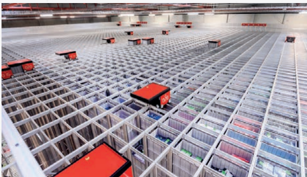
Herzstück: Das AutoStore-System mit über 50 Robotern. Diese steuern insgesamt 150.000 Kisten mit über 3,5 Mio. Produkten.
