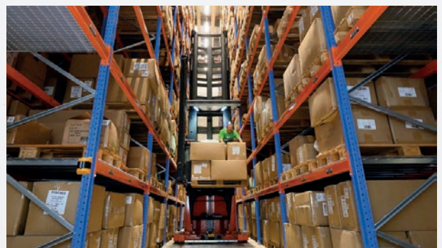
Neben dem AutoStore-System gibt es einen weiteren Lagerbereich. Das 20 m hohe Hochregallager bietet Platz für großvolumige und sperrige Güter, wie Bälle, Taschen oder andere Accessoires, die nicht in die Kisten passen.
